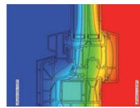
Mehr Behaglichkeit durch bessere U<sub>w</sub>-Werte, weniger Kondensatgefahr und höhere Oberflächentemperaturen.
